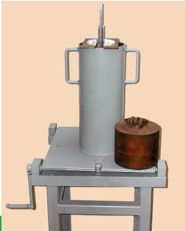
L'essai proposé dans ce document a pour but de mesurer la compacité d'une fraction granulaire de masse déterminée lorsqu'elle est soumise, dans un cylindre, à une sollicitation mécanique définie. Le mode opératoire exposé s'applique aux granulats d'origine naturelle ou artificielle utilisés dans le domaine du bâtiment et du génie civil.
